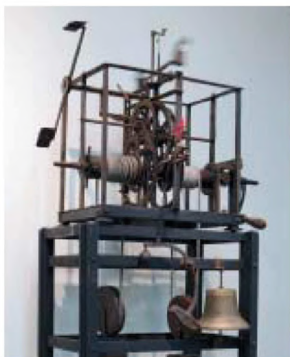
【写真1】自動鐘つき装置付塔時計：古くから教会では、お祈りの時間を知らせるために鐘をつくことで時刻を知らせていた。1300年前後になると教会の鐘も手動ではなく、機械仕掛けて鳴らされるようになった
