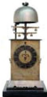
【写真3】大名時計：棒天符が2本付いており、昼は上の棒天符が、夜は下の棒天符が動く
