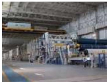
最新鋭の抄紙機 王子製紙富岡工場のN-1マシン。製品最大幅9,180mm、日産1,000トン。1分間に1,800mの高速で微塗工紙、A3コート紙を生産。近代的な抄紙機が今日の膨大な洋紙需要に応えている（写真提供：王子製紙株式会社）
